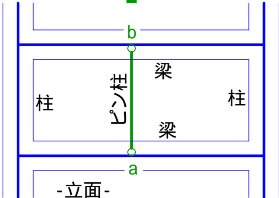
ピン柱でa,b点の鉛直変形が関連づけられる
