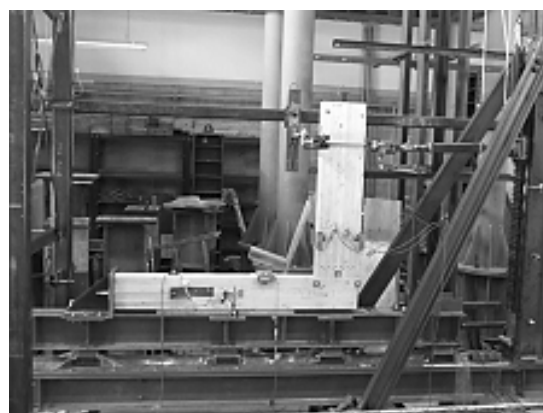
写4 柱頭要素試験【CTシリーズ】 (2008年度は加力点高さを変数とする)
