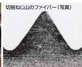
ファイバーはねじ山で切断されている。
