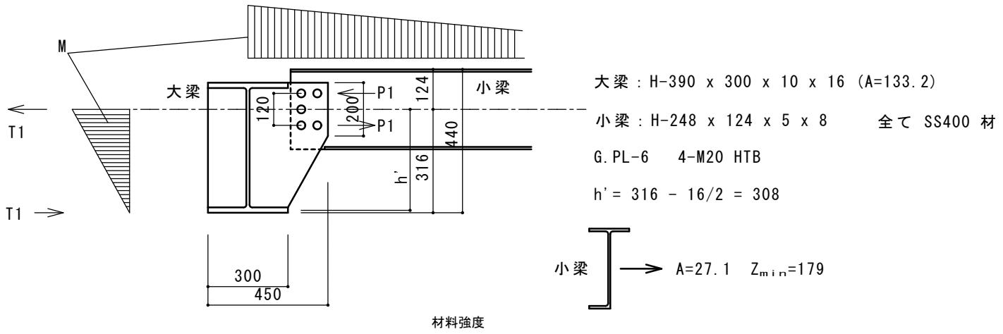
1) ガセットプレートの検討 曲げと軸力を受ける
