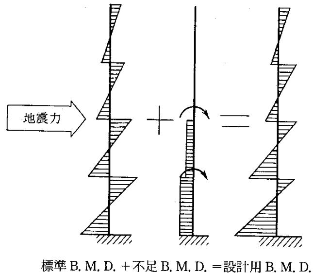
解説図 6.1 壁梁の不足曲げモーメントの処理
