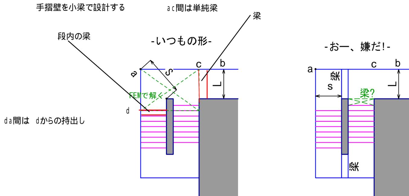
片持ち床先端にRC手摺り(H=1.1m程度)が付くと、b点変形は大きい
