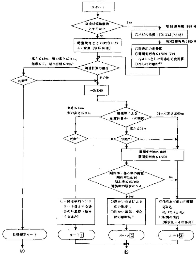
図 6.6-1 構造計算ルートと仕様規定の適用関係のフロー（次ページへ続く）
