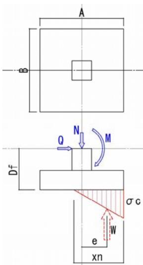
$A=B=3\text{m}$  X方向地震正加力
