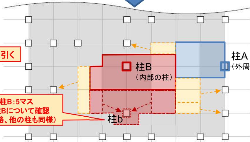
柱b:4マス < 柱B:5マスとなるため、柱Bについて確認(柱は検討省略、他の柱も同様)
