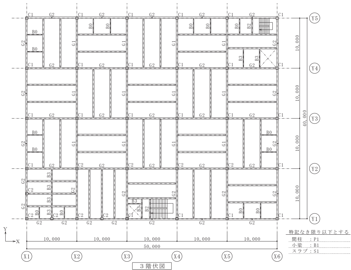
図 2.6 3,R階伏図 (図中の数値の単位 : mm)
